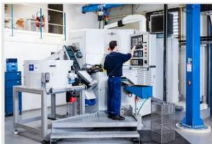
La rectification plane permet d'ajuster les pièces après découpage. © Gris Group.
